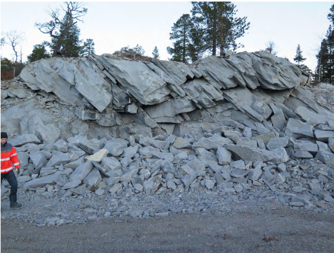
Foto 8: Profil ~5700, Eksempel på tydelig oppsprekking langs foliasjonen.
