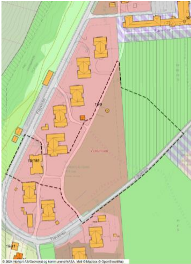
Figur 2-2. Gjeldende reguleringsplan med innlagt varslet plangrense vist med stiptet linje. Grønt område med skravur er det friområdet regulert til bevaring. (Kilde: Planbeskrivelsen samt Nordkart)
